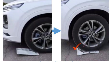
[멜라민 식판은 차량 하중 테스트 후 완전히 부서짐]
